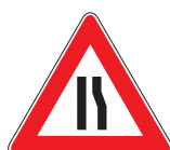
Fig. 19 STRETTOIA ASIMMETRICA A DESTRA
