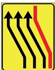
Fig.412/f SEGNALE DI RIENTRO IN CARREGGIATA
