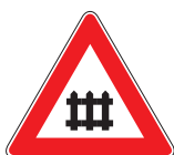
Fig. 8 PASSAGGIO A LIVELLO CON BARRIERE
