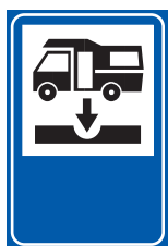
Fig. 377 AREA ATTREZZATA CON IMPIANTI DI SCARICO
