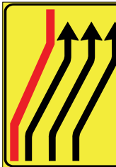
Fig.411/e SEGNALE DI CORSIE CHIUSE
