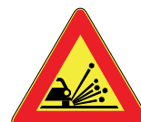
Fig. 390 MATERIALE INSTABILE SULLA STRADA
