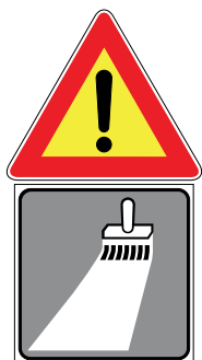
Fig. 391 SEGNALI ORIZZONTALI IN RIFACIMENTO. Esempio di montaggio con due figure.
