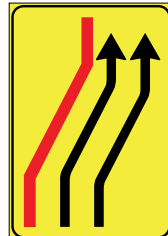
Fig.411/d SEGNALE DI CORSIE CHIUSE
